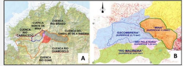
Şekil 3: (A) Eume nehri havzası ve As Pontes açık ocak gölünün doldurulmasında kullanılan doğal su havzaları. (B) Maden ve dış atık depolama alanlarının drenaj havzaları ile Peleteiro ve Maciñeira nehir havzaları (ENDESA, 2003a)
